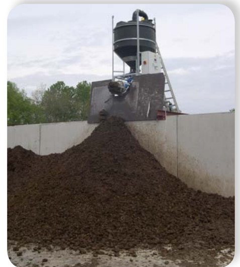
Le séparateur de phase et le digestat solide
